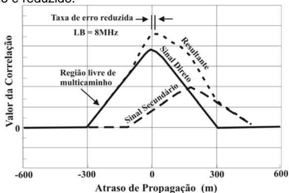
Figura 5 – Taxa de erro reduzida causada pelo multicaminho (LB = 8MHz) Fonte: Weill, 1997a.
